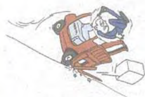
การขึ้นที่ชันให้เดินหน้าขึ้น และเมื่อจะลงที่ลาดต่ำให้ถอยหลังลง
